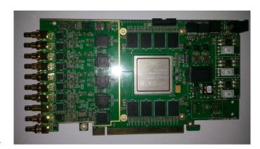
支持波形:正弦波、方波、三角波、脉冲、自定义波形
